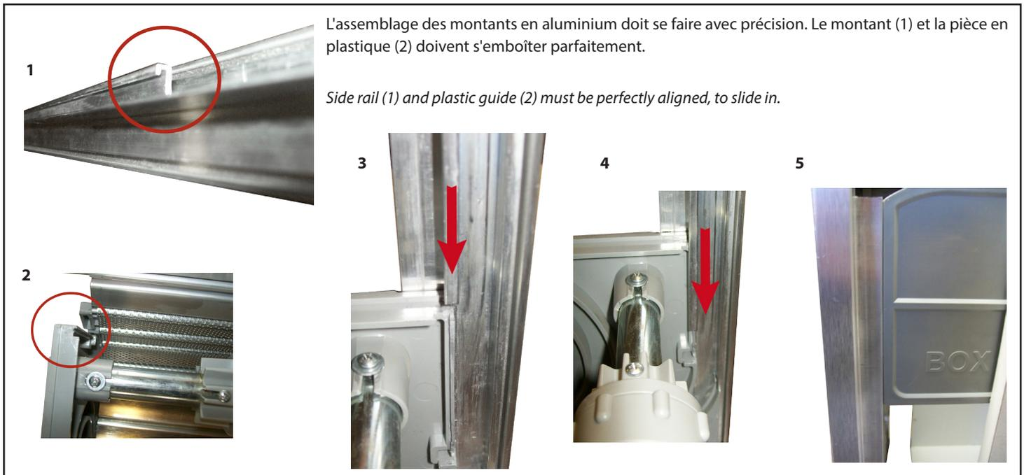
L'assemblage des montants en aluminium doit se faire avec précision. Le montant (1) et la pièce en plastique (2) doivent s'emboîter parfaitement.
